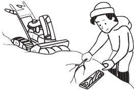
En cas d'obstacle pendant des travaux de déneigement, arrêter immédiatement le moteur et vérifier si la déneigeuse n'a pas subi de dommage. Un matériel endommagé pourrait accroître les risques de blessures pendant le fonctionnement.
